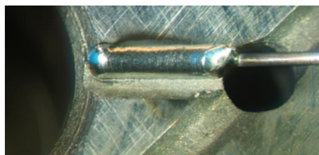
Repairs with filler wire / Riparazione con filo d'apporto
