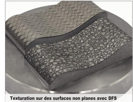
Texturation sur des surfaces non planes avec DFS
