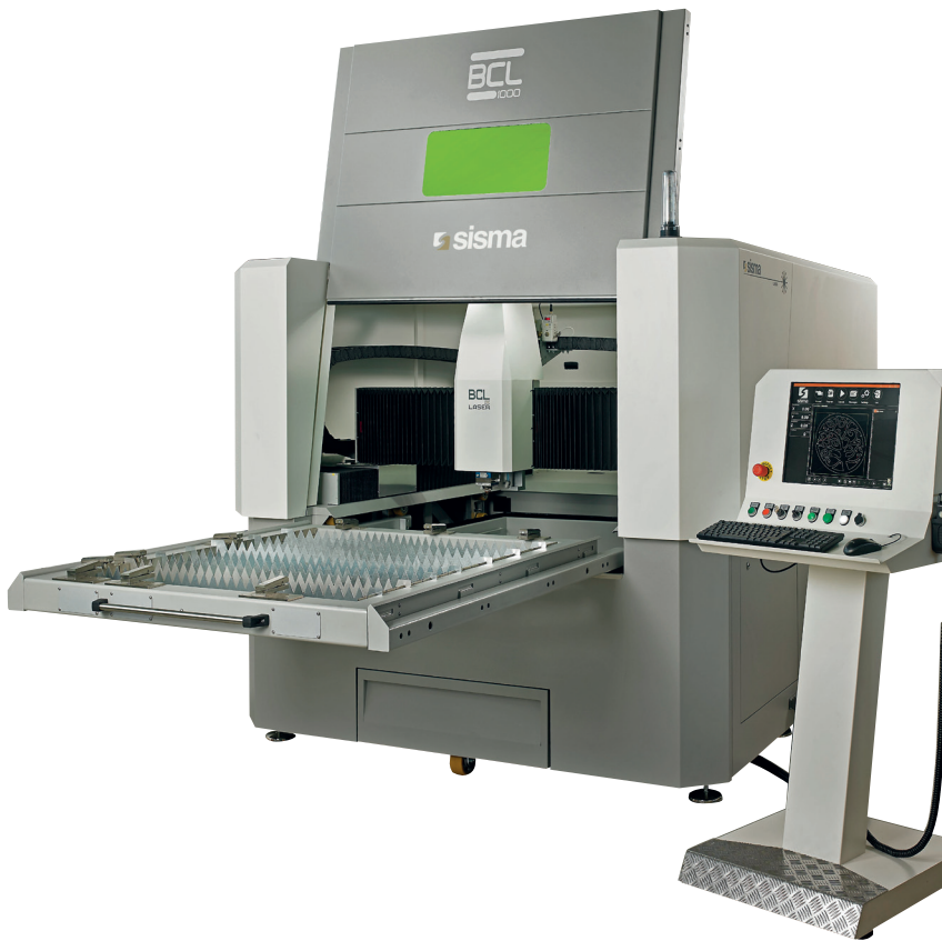
Cassetto raccolta pezzi integrato totalmente estraibile per essere trasportato
