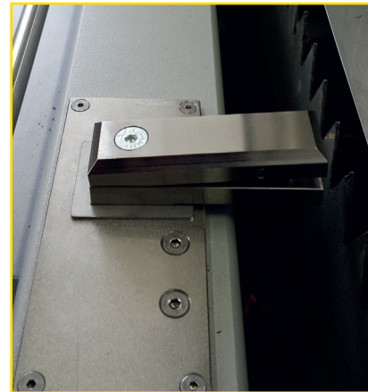
Morsa di fissaggio con trazione per piccoli spessori
